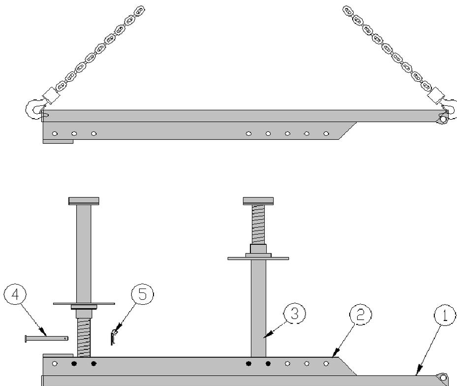
Теперь можно отрегулировать длину распорок и соответственно рабочую ширину траншеи. При этом необходимо учесть, что нижняя распорка должна быть примерно на 2-4 см длиннее верхней. Этим обеспечивается А-образное расположение стенок крепи. Расстояние А должно обязательно быть больше, чем расстояние С.
